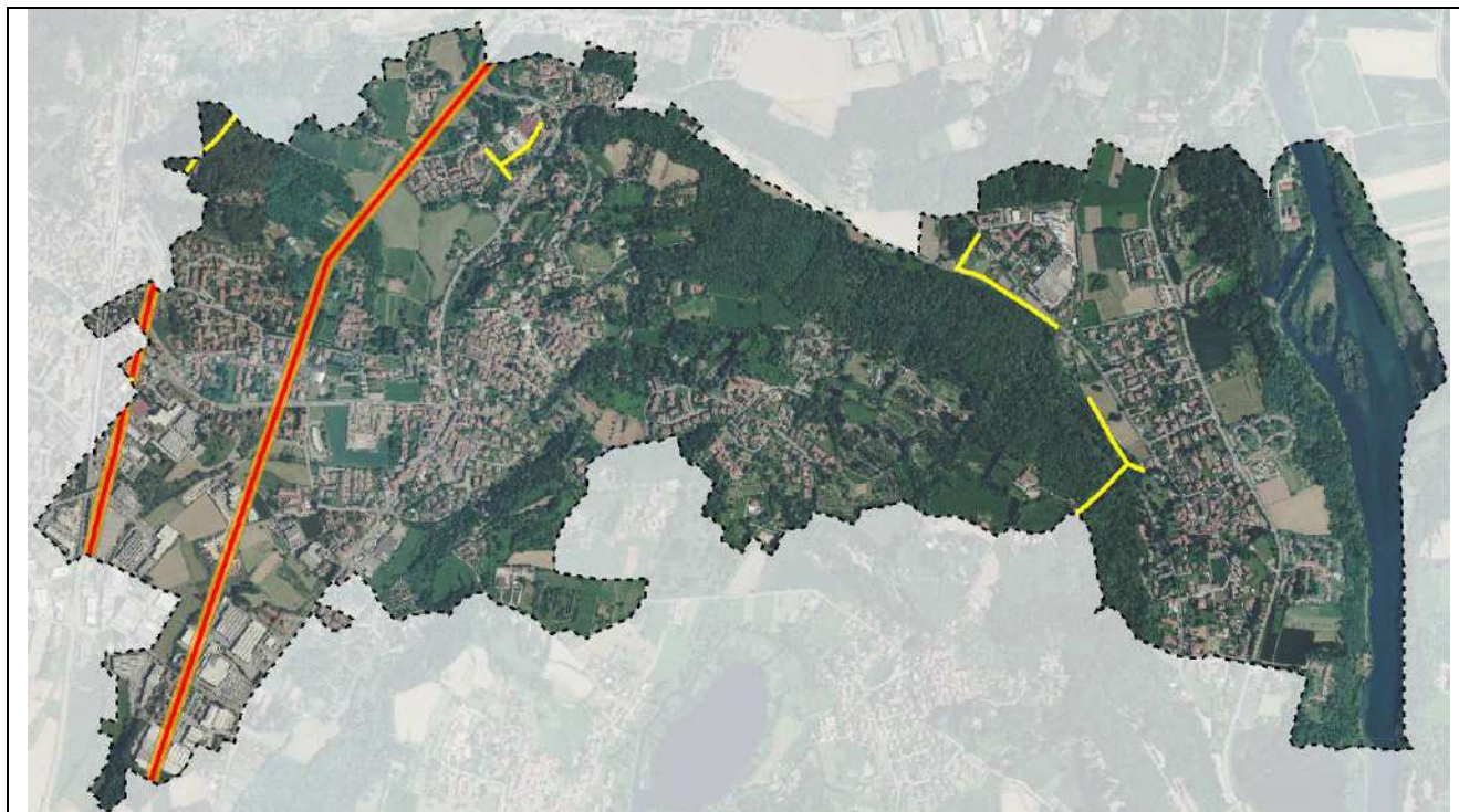
Figura 101: Elettrodotti ad alta tensione (in rosso) con fascia di rispetto/DPA (in arancione) e a media tensione (in giallo) che attraversano il territorio comunale di Calco.
